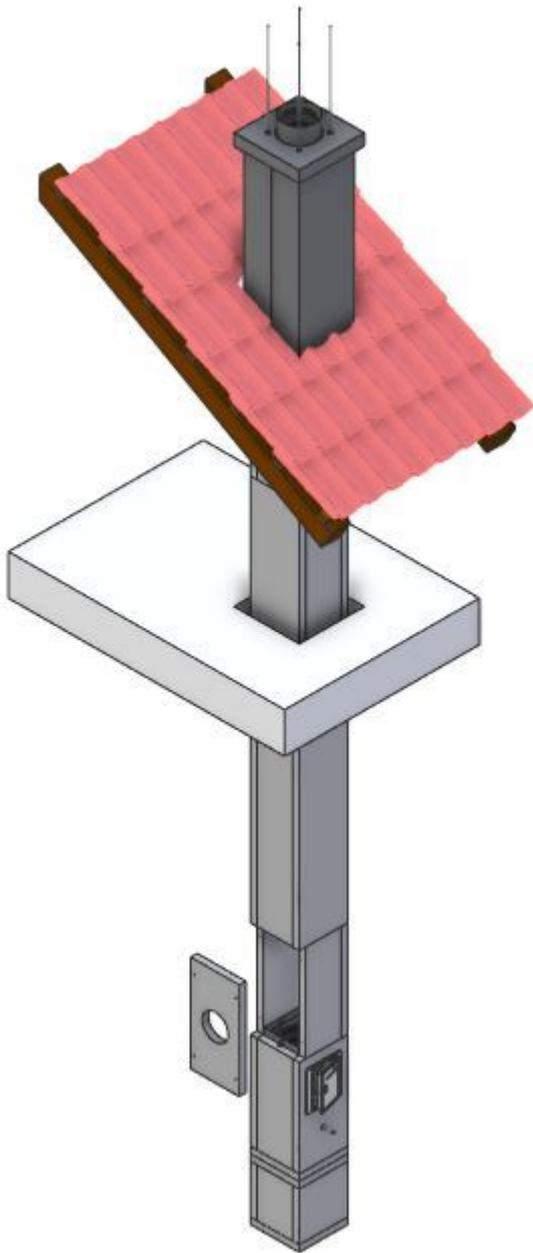
Das Schachtsystem wird für Montageabgasanlagen aus Silikat Brandschutzplatten mit 40mm Wandstärke hergestellt.
