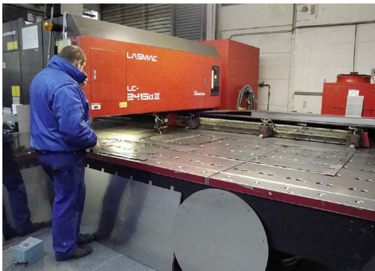
▲ Modernste Anlagentechnik, hier ein CNC-gesteuerter Laserschneider, sorgt für die erforderliche Präzision und höchste Fertigungsqualität.
