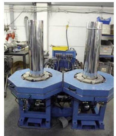
▲ Entscheidend für eine passgenaue und gasdichte Verbindung: Hier werden die Edelstahlrohre an der Aufweitmaschine weiterverarbeitet.
